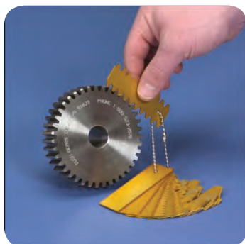
استفاده از شابلن در کنترل دندهی چرخ دنده
