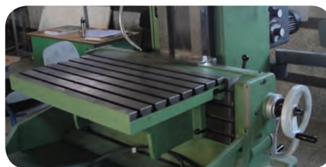
میز ماشین فرز و سیستم حرکتی آن
