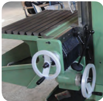
مکانیزم جابجایی میز ماشین
