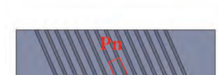
معرفی گام نرمال در چرخ‌دنده شانه‌ای مایل
