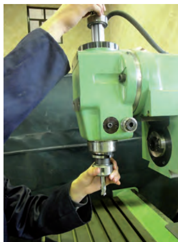
نحوه بستن کُلت بر روی دستگاه
