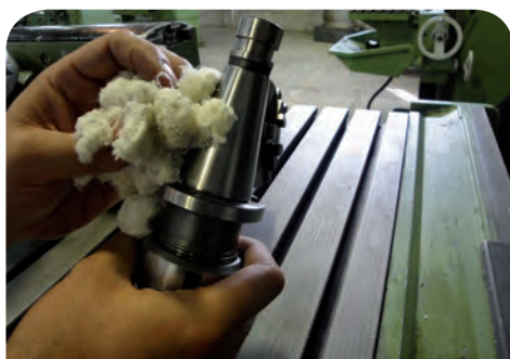
تمیز کردن دنباله میله فرزگیر
