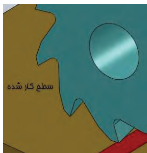
معرفی سطح کار شده در فرز کاری
