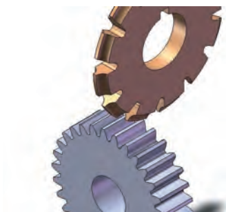
نمایش تیغه فرز مدولی و قطعه کار
