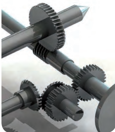
سیستم انتقال دور بین قطعه کار و صفحه سوراخ‌دار در روش اختلافی
