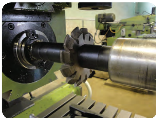
بستن تیغه فرز مدولی بر روی میله فرزگیر یک و دو طرفه
