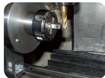
چهارگوش کردن قطعه به کمک دستگاه تقسیم
