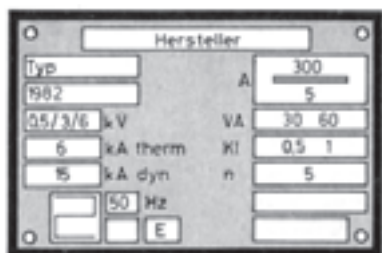
شکل ۵-۶۷- تابلوی مشخصات ترانسفورماتور جریان
