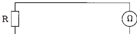
شکل ۵۴-۵- مدار اتصال اهم متر به مقاومت
