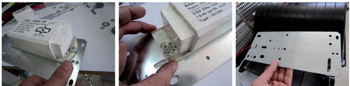
شکل ۲-۳۹ - نحوه نصب بالاست در نورافکن
