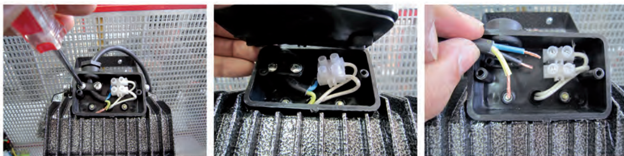
شکل ۲-۲۵ - سیم کشی در جعبه اتصالات
