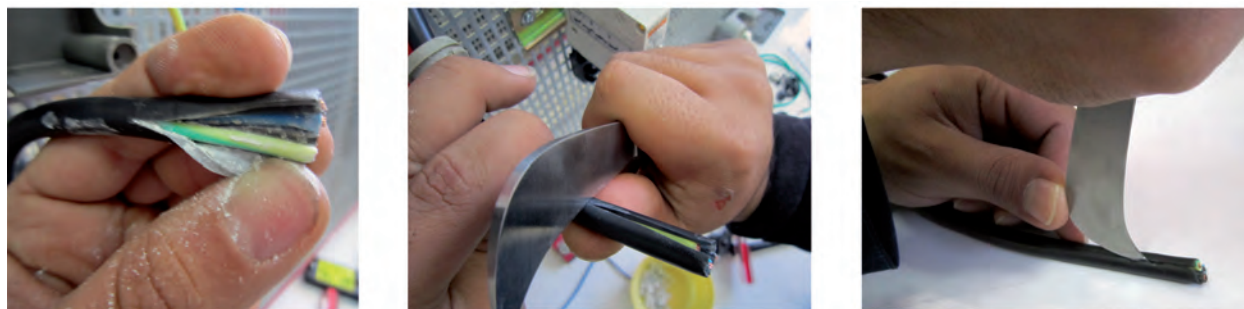
شکل ۲-۲۲ - بریدن و لخت کردن کابل
