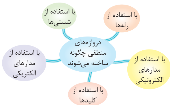
شکل ۱۷-۴- وسایل مورد استفاده در ساخت دروازه‌های منطقی
