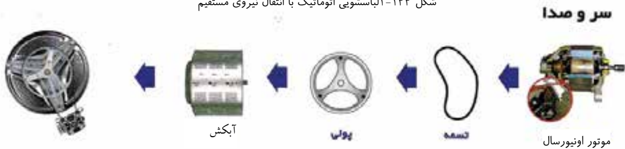
شکل ۱-۱۴۵-الباسشویی اتوماتیک با انتقال نیروی غیرمستقیم
