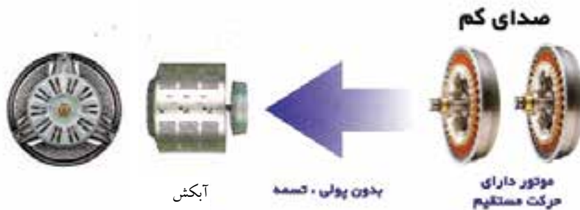
شکل ۱-۱۴۴-الباسشویی اتوماتیک با انتقال نیروی مستقیم
