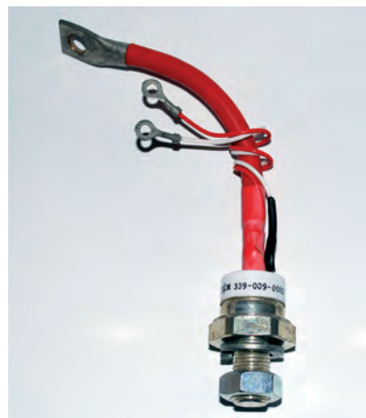
شکل ۳-۱- یک تریستور نوع استود
