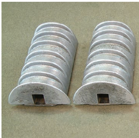
شکل ۲-۳- قالب کلاف مساوی
