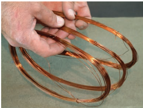
شکل ۱۹-۳- درآوردن کلاف از قالب
