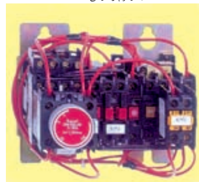
(b) تایمر پنوماتیکی نصب شده روی کنتاکتور شکل ۱-۲۶۳
