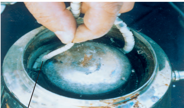
شکل ۲-۲۱ محلی که عایق‌بندی ضعیف است
