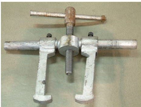
شکل ۱-۴۸- ابزار درآوردن بوش و یاتاقان‌های استوانه‌ای
