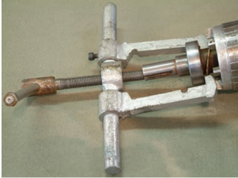
شکل ۱-۴۶- استقرار بلبرینگ کش روی محور روتور
