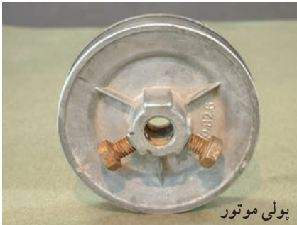
شکل ۱-۲۵- باز کردن پولی موتور
