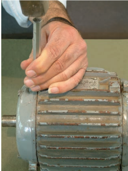
شکل ۱-۲۳- علامت‌گذاری روی پوسته و درپوش‌ها
