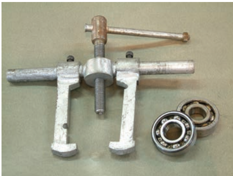
شکل ۱-۴۷- بلبرینگ‌ها پس از جدا شدن از محور
