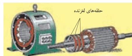
شکل ۱-۴۶- اجزای موتور روتور سیم‌پیچی
