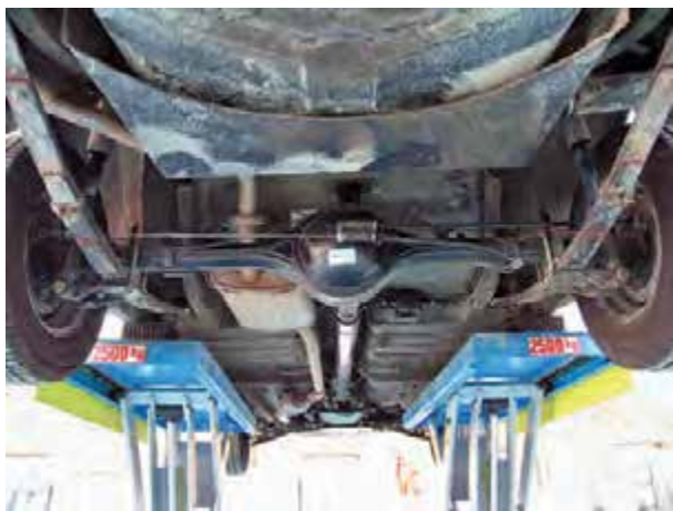
شکل ۳۱۵- دیفرانسیل در خودرو محرک عقب
