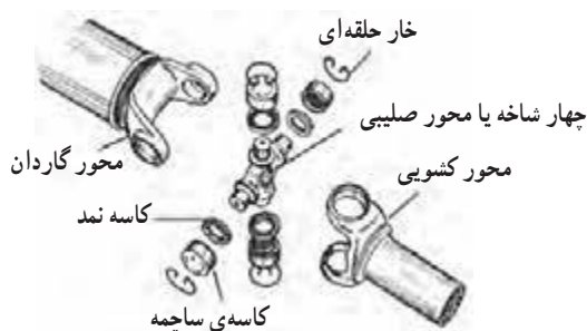
شکل ۲۹۱- اجزای قفل گاردان
