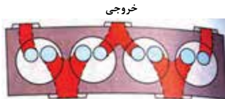
ورودی سوپاپ‌ها به صورت قرینه قرار دارند
