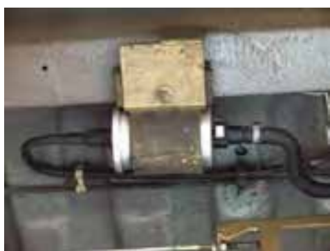
شکل (۲-۶۷) بست های دوطرف فیلتر سوخت
