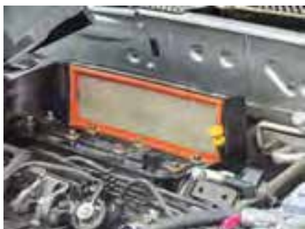
شکل (۲-۶۲) فیلتر سیستم هوارسانی
