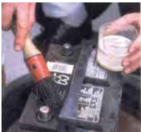
شکل (۲-۸۴) تمیز کردن قطب ها با استفاده از محلول جوش شیرین
