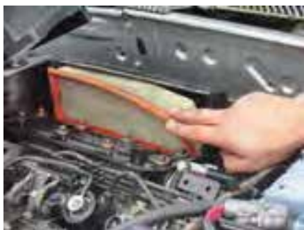
شکل (۲-۶۴) پیاده کردن فیلتر هوا
