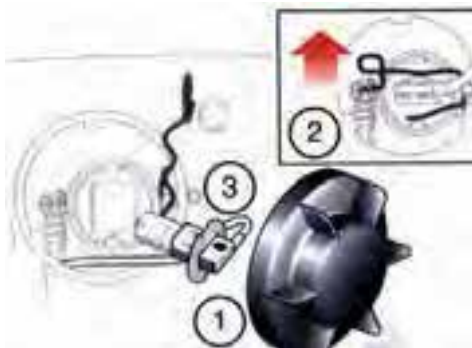
شکل (۱۰۰-۲) تعویض لامپ چراغ مه شکن جلو
