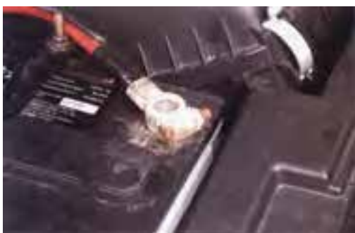
شکل (۲-۸۱) سولفاته شدن بست باتری
