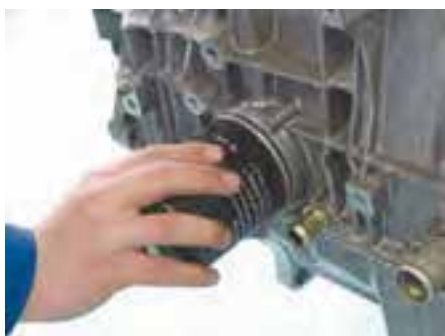
شکل (۲-۵۴) نصب و محکم کردن فیلتر
