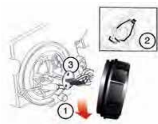
شکل (۲-۹۴) تعویض لامپ چراغ جلو نور بالا
