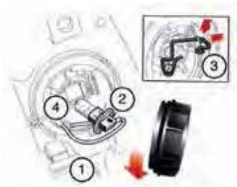
شکل (۲-۹۵) تعویض لامپ چراغ نور پایین
