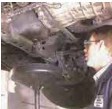
شکل (۲-۵۵) کنترل تخلیه شدن کامل روغن
