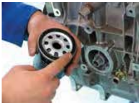
شکل (۲-۵۳) کنترل دندانه و واشر لاستیکی فیلتر
