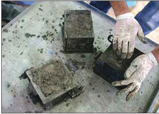
شکل ۱-۵۱ آزمایش مقاومت بتن
