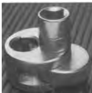
شکل (۲۶-۱) آچار پیچ‌های دوسر دنده
