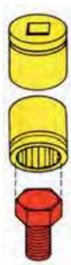
شکل (۱-۱۷) نحوه درگیری آچار بوکس
