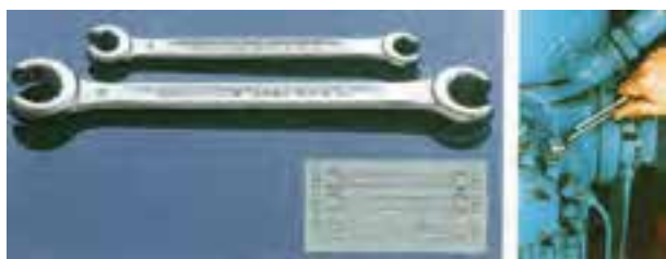
شکل (۱۵-۱) دو نوع آچار رینگی خاص
