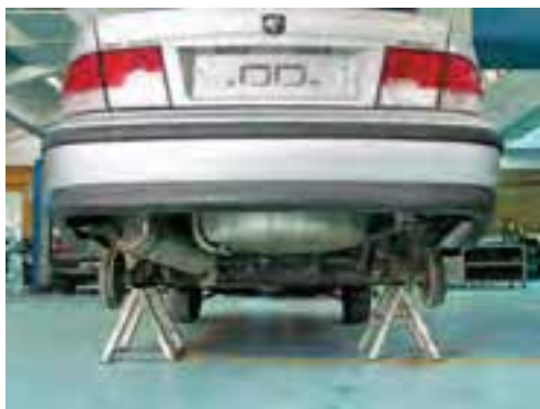
شکل (۱-۵۷) بالابر خودروی پایه‌ی ثابت
