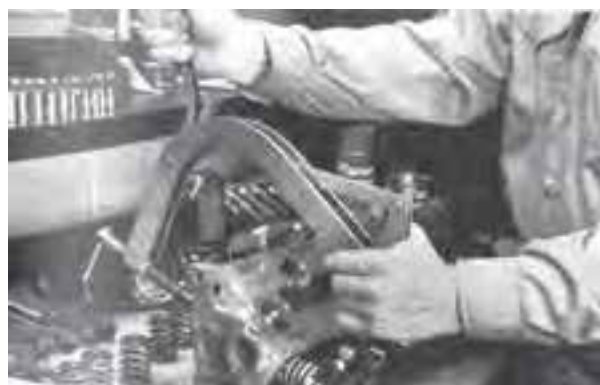
شکل (۱-۵۲) استفاده از فنر جمع کن سوپاپ
