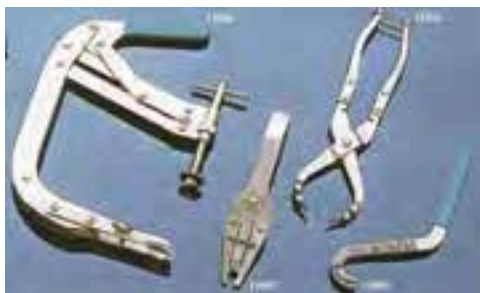
شکل (۱-۷) فنر جمع کن سوپاپ
