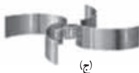
شکل ۱-۲-۱ انواع پره توربینی
