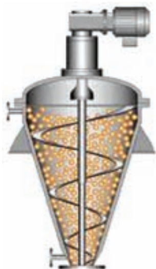
شکل ۱۰-۱۱- مخلوط‌کن ماریچ عمودی
