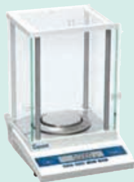
شکل ۴-۵- ترازوی یک کفه‌ای الکتریکی ۲ (دیجیتالی)
