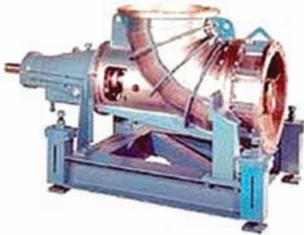
شکل ۱۲-۶- پمپ گریز از مرکز با جریان محوری
