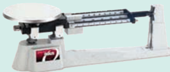
شکل ۲-۵- ترازوی یک کفه‌ای سه اهرمی ۸ (مکانیکی)
