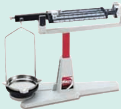
شکل ۳-۵- ترازوی یک کفه‌ای آویزان سه اهرمی ۱ (مکانیکی)
