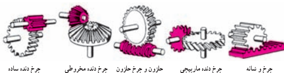
نمونه هایی از انواع چرخ دنده ها
