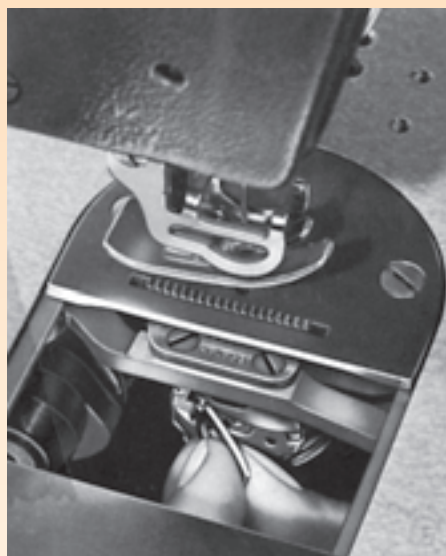
شکل ۶- طریقه‌ی برداشتن ماکو از زیر چرخ
