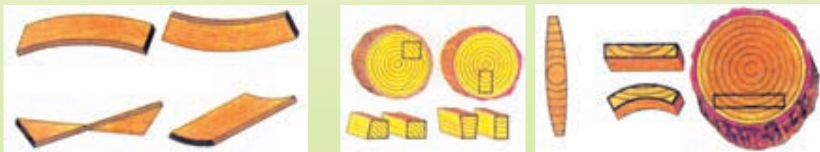
چوب‌های نازک بر اثر هم‌کشیدگی کج می‌شوند.
