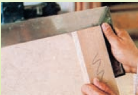
آزمایش عمود بودن عرض نسبت به طول چوب
