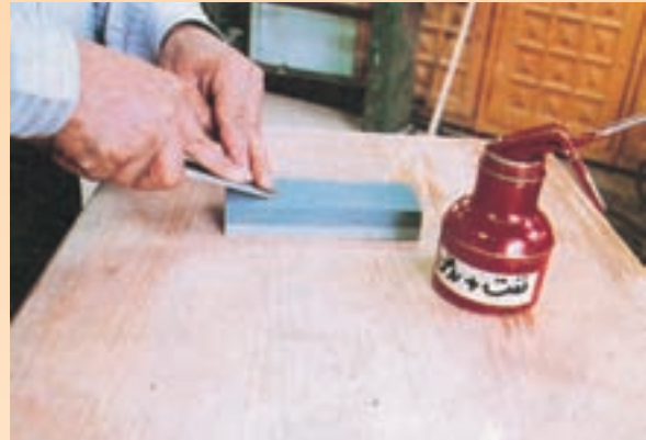
نحوه‌ی تیزکردن مغار با سنگ نفت
