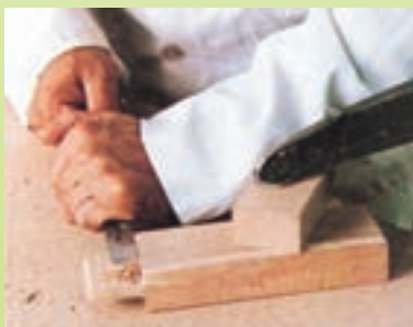
نحوه‌ی بستن قطعه کار به میز توسط پیچ دستی
