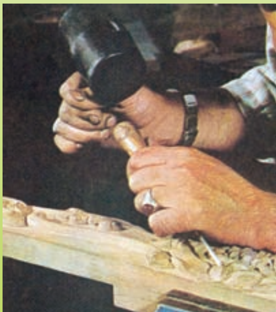
نحوه‌ی ضربه زدن با چکش به انتهای مغار
