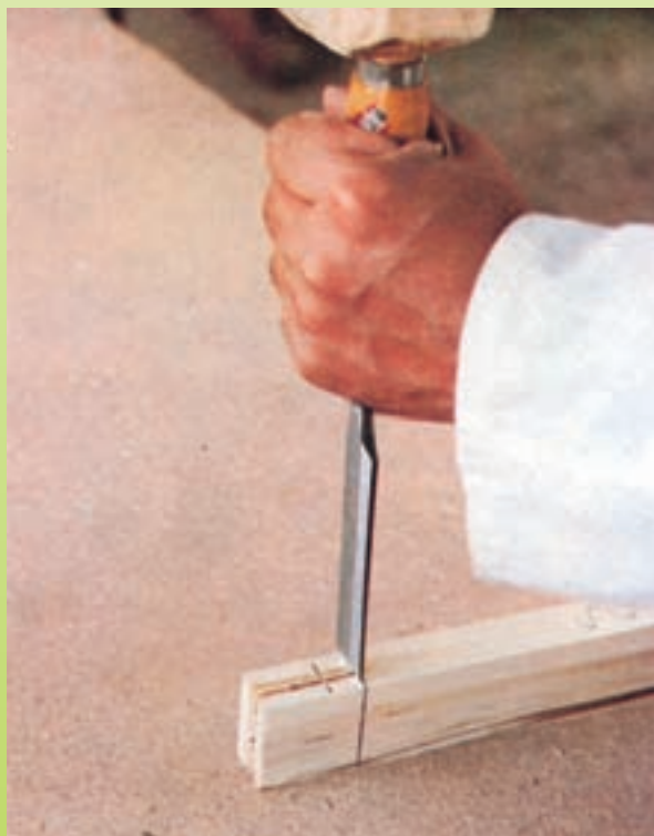
نحوه‌ی کاربرد مغار در عملیات فاق در آوردن
