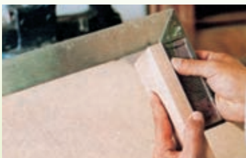
آزمایش عمود بودن ضخامت نسبت به سطح چوب
