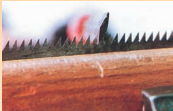
قرارگیری سوهان بین دندان‌ها
