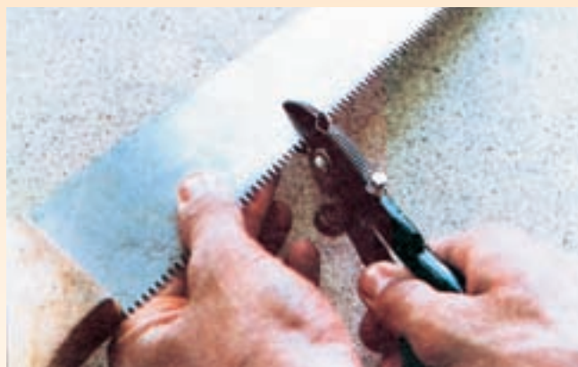
نحوه‌ی چپ و راست کردن دندانه‌های اره با انبر یا گاز چپ و راست‌کن
