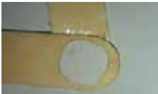
ج - واشر پولکی بدون سوراخ را روی محل پرچ قرار دهید و آن را با دست نگاه‌دارید تا بچسبد.
