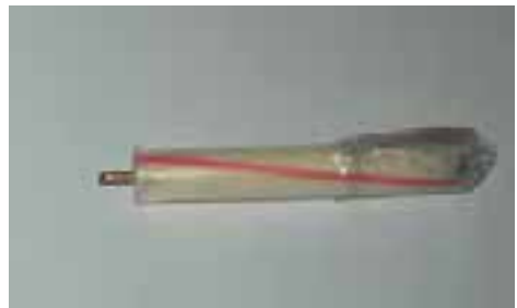
ب) بستن ته مجموعه نی و کابل آنتن به صورت تکیه‌گاه
