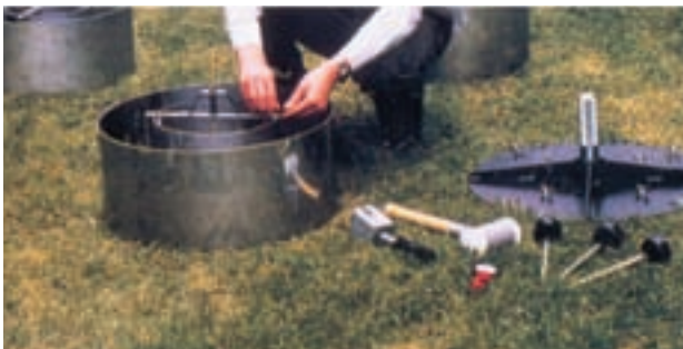
شکل ۳۰-۱ نحوه کار گذاشتن استوانه مضاعف
