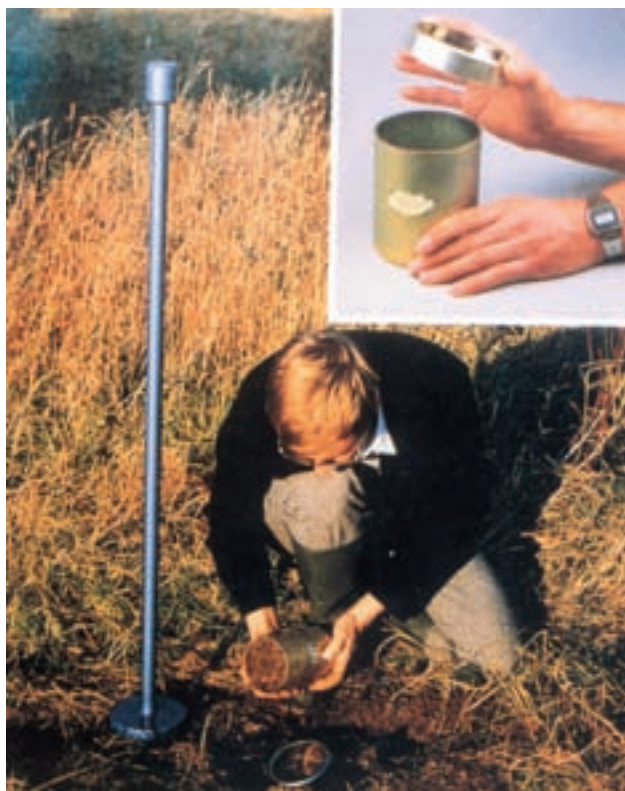
شکل ۱۶- ۱ نمونه برداری از خاک با سیلندر
