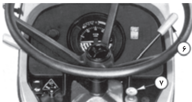
۶- اهرم گاز دستی ۷- اهرم خاموش کن
