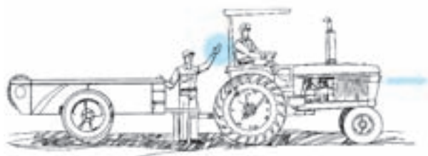
شکل ۱-۲۵ موقع کمک به راننده در بین تراکتور و ادوات قرار نگیرید.
