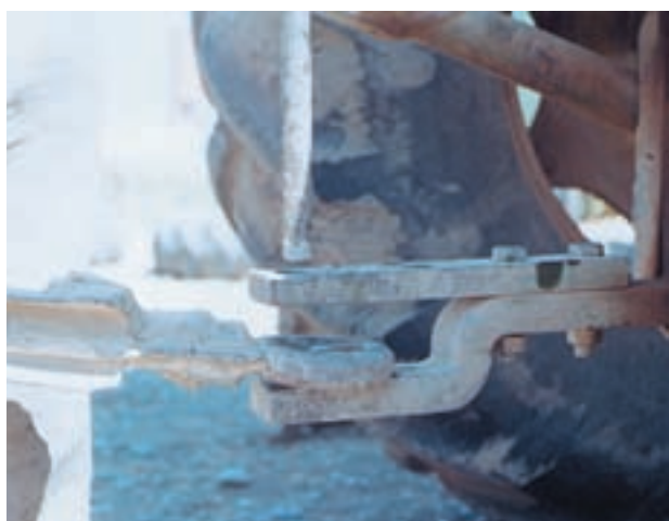
شکل ۳۶-۱ باز کردن پی نورد از تراکتور
