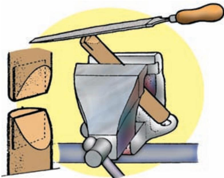
اکنون سطح مقطع هر کدام از آن‌ها را به اندازه‌ی ۲ سانتی‌متر با اره شکاف می‌دهیم، قطعه چرمی را انتخاب و پس از آغشته کردن آن به چسب چوب درون شکاف قرار می‌دهیم و برای محکم شدن به هر کدام از قسمت‌های آن دو عدد میخ می‌کوییم.
