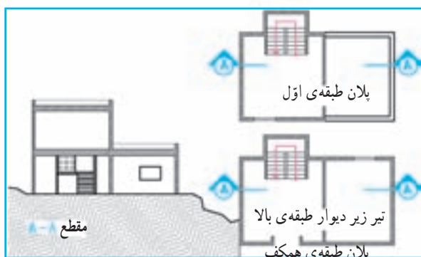
شکل ۱۶-۴- روش ترسیم پلان‌های طبقات
