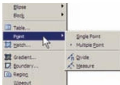
فرمان Point تنها یک نقطه بر روی صفحه‌ی ترسیم قرار می‌دهد و با استفاده از فرمان Multiple Point می‌توان به تعداد مورد نیاز نقطه در صفحه ایجاد نمود. برای خروج از فرمان اخیر لازم است از کلید Esc استفاده نمایید. ملاحظه می‌کنید که کلیه‌ی نقطه‌های رسم شده بسیار ریزند و
