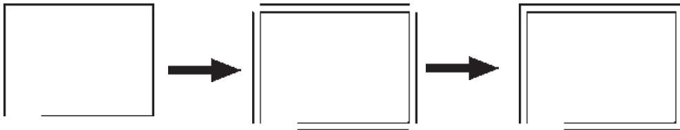
**اتصال (Join):** فرمان Join یا دکمه‌ی عملیاتی، بر عکس فرمان قطع (Break)، دارد. به این ترتیب که هرگاه لبه‌های دو شکل با یکدیگر در تماس باشند اما یکی نباشند، این دو را به یک چندخطی (Polyline) تبدیل می‌کند. توجه نمایید که این فرمان برای شکل‌هایی، که به یکدیگر نرسیده‌اند یا از هم دیگر عبور کرده‌اند، عمل نمی‌کند. این دستور زمانی عمل می‌کند که خطوطی که یک پارچه نیستند در یک جهت باشند و اگر راستای یکی از آن‌ها با دیگری متفاوت باشد این فرمان کاربردی ندارد.
