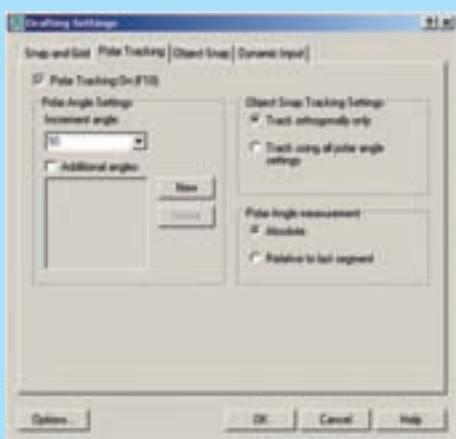
در بخش Increment angle زاویه‌ای پیش‌فرض در پنجره‌ی Polar Angle Settings تعیین می‌شود که وقتی  $90^\circ$  باشد راستاهای افقی و عمودی را شامل می‌شود. اگر کاربر بخواهد زوایای دیگری را به این مکان اضافه نماید، باید گزینه‌ی Additional angles را فعال نماید و با کلیک بر دکمه‌ی New، زوایای جدید را در آن تایپ کند. در صورت نیاز به حذف هر کدام از زوایای اضافی، آن را انتخاب و از دکمه‌ی Delete استفاده می‌کند.
