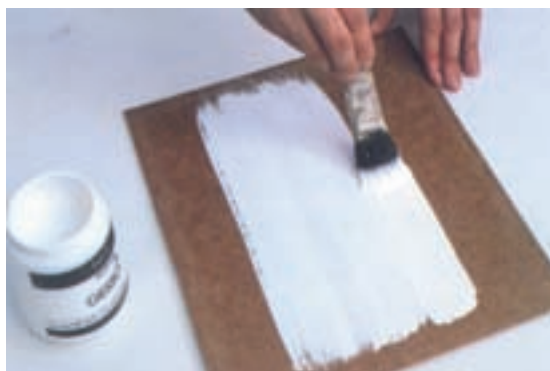
تصویر ۱- کشیدن ماده نفوذناپذیر (جسو) روی فیبر
