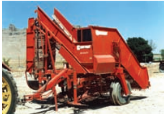
الف- بردارنده بارکن در حالت حمل
