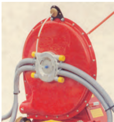
شکل ۷-۱۳- پمپ مکنده و درجه باد
