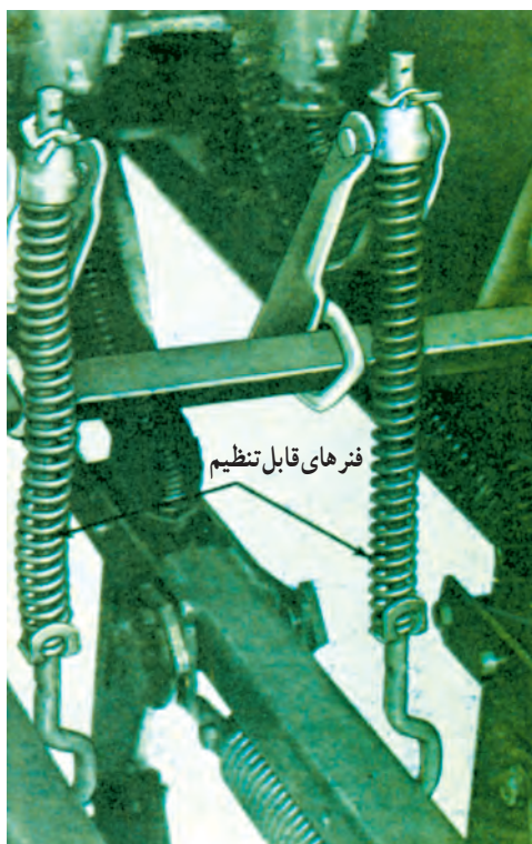
شکل ۱۶-۶- تنظیم عمق کاشت توسط فنر
