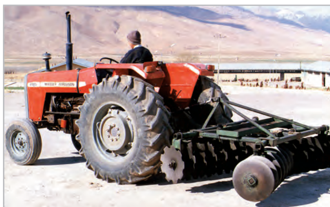
شکل ۲-۶- چنگه بشقابی سوار در حالت حمل
