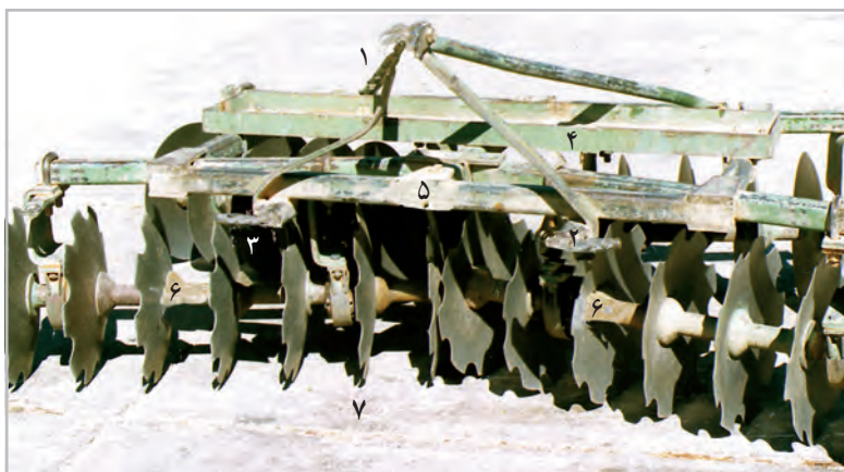
شکل ۲-۲- اجزای چنگه بشقابی دو زانویی سوار
