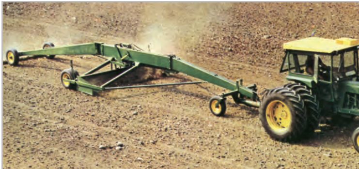
شکل ۲۷ - ۲ - تسطیح‌کن کششی سنگین حین کار
