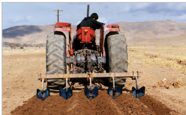
شکل ۳-۱- دستگاه شیارکش در حین کار
