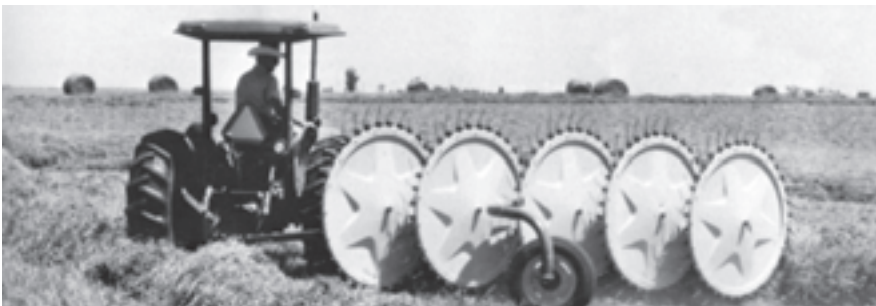
شکل ۹-۵- شانه چرخشی با چرخ انگستی مخصوص نقاط بادخیز
