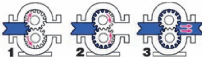
شکل ۱-۳- مراحل کار پمپ دنده خارجی
