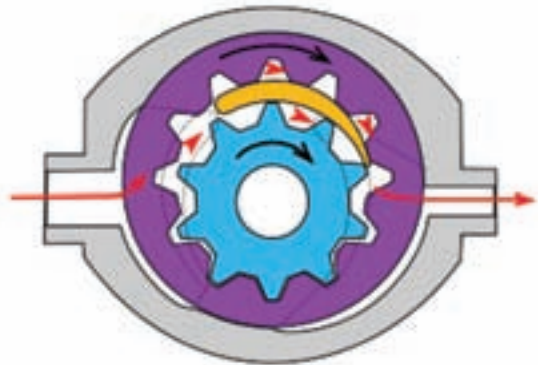
شکل ۳-۴- اجزای ساختمانی پمپ دنده داخلی
