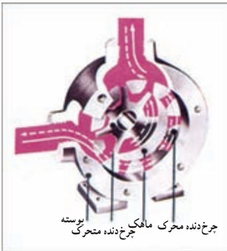
شکل ۳-۵- طرز جریان سیال در پمپ دنده داخلی
