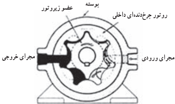
شکل ۳-۷- طرز کار پمپ ژیراتور
