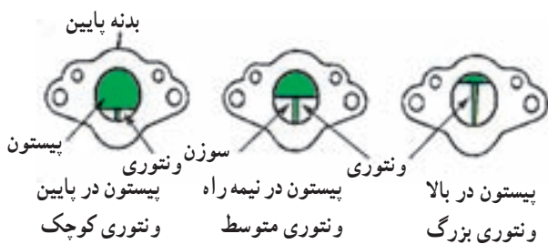
شکل ۹-۹- اجزای کاربراتور و نتوری متغیر
