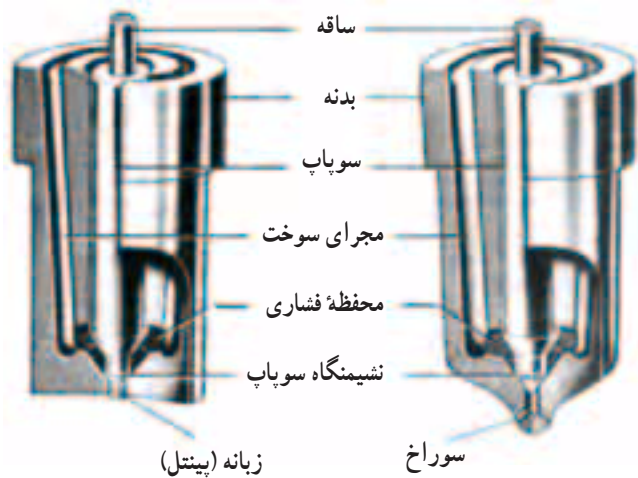
شکل ۱۹-۵ - قسمت‌های مختلف افشانک: نوع سورخ‌دار (سمت راست)، و نوع زبانه‌ای یا پینتل (سمت چپ)
