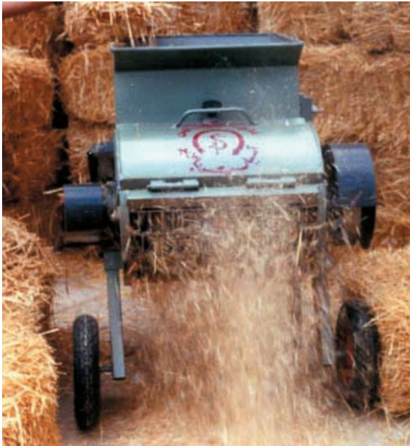
شکل ۳-۴- نحوه کار کاه خردکن
