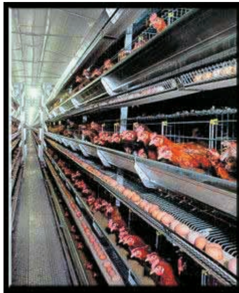
شکل ۷۵-۳- ناودانی دان و محل جمع‌آوری تخم مرغ در قفس پرورش مرغ تخمگذار
