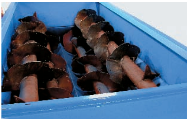
شکل ۴-۵- ماریچ‌های مخلوط‌کن در مخزن مواد
