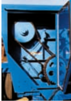
شکل ۷-۴- چرخ زنجیر و زنجیر انتقال نیرو
