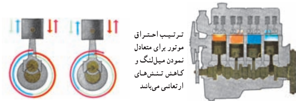
شکل ۲۱-۳- تایمینگ سوپاپها و زمان کار موتور
