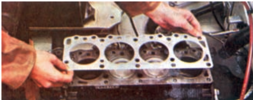
شکل ۵-۳- واشر سرسیلندر
