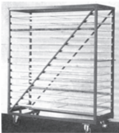
شکل ۳-۳ — قفسه‌های مخصوص شانه‌های تخم مرغ (راک)
