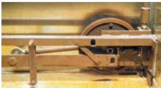
شکل ۱۲-۳- روش مکانیکی چرخش تخم مرغها در جوجه گذار
