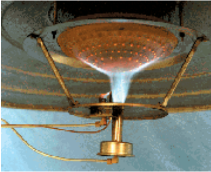
شکل ۳۰-۳- چگونگی توزیع شعله روی بازتابنده سرامیکی
