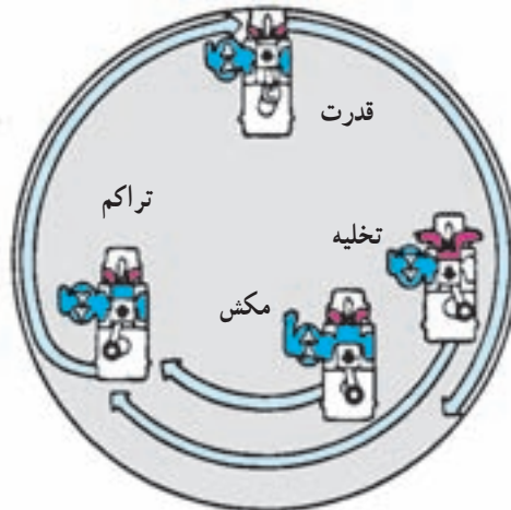
شکل ۱۲-۲- چرخه موتور دوزمانه
