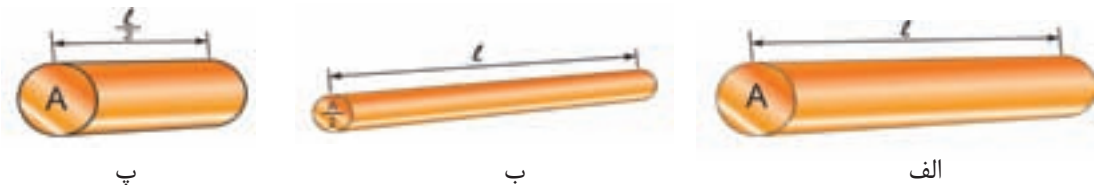
شکل ۱۹-۱ سیم‌ها در طول‌ها و سطح مقطع‌های متفاوت
