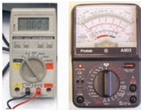
شکل ۳۷- ۱ مولتی متر آنالوگ و دیجیتال
