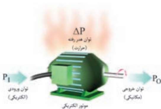
شکل ۵۴- ۱ توان و تلفات در موتور الکتریکی
