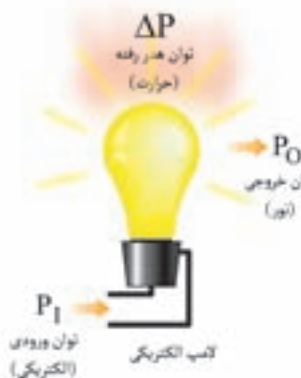
شکل ۵۵- ۱ توان و تلفات در لامپ معمولی
