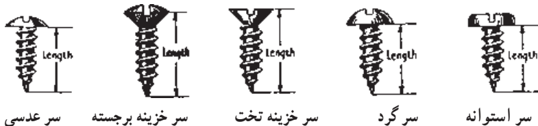
شکل ۱-۴۵ - انواع پیچ خودرو برای اتصالات فنی
