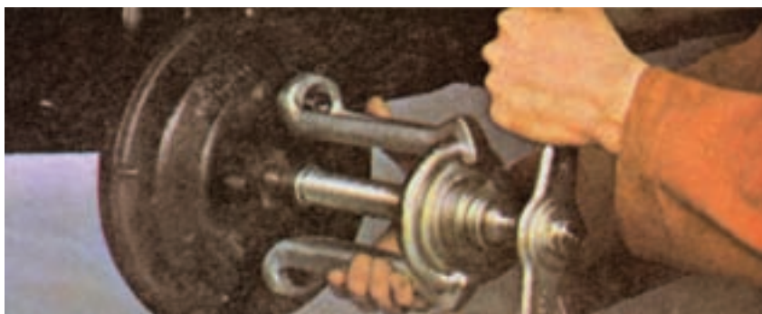
شکل ۱-۳۴- روش درآوردن کاسه چرخ
