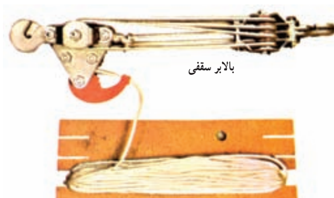
شکل ۱-۳۳- کابل و بالابر سقفی
