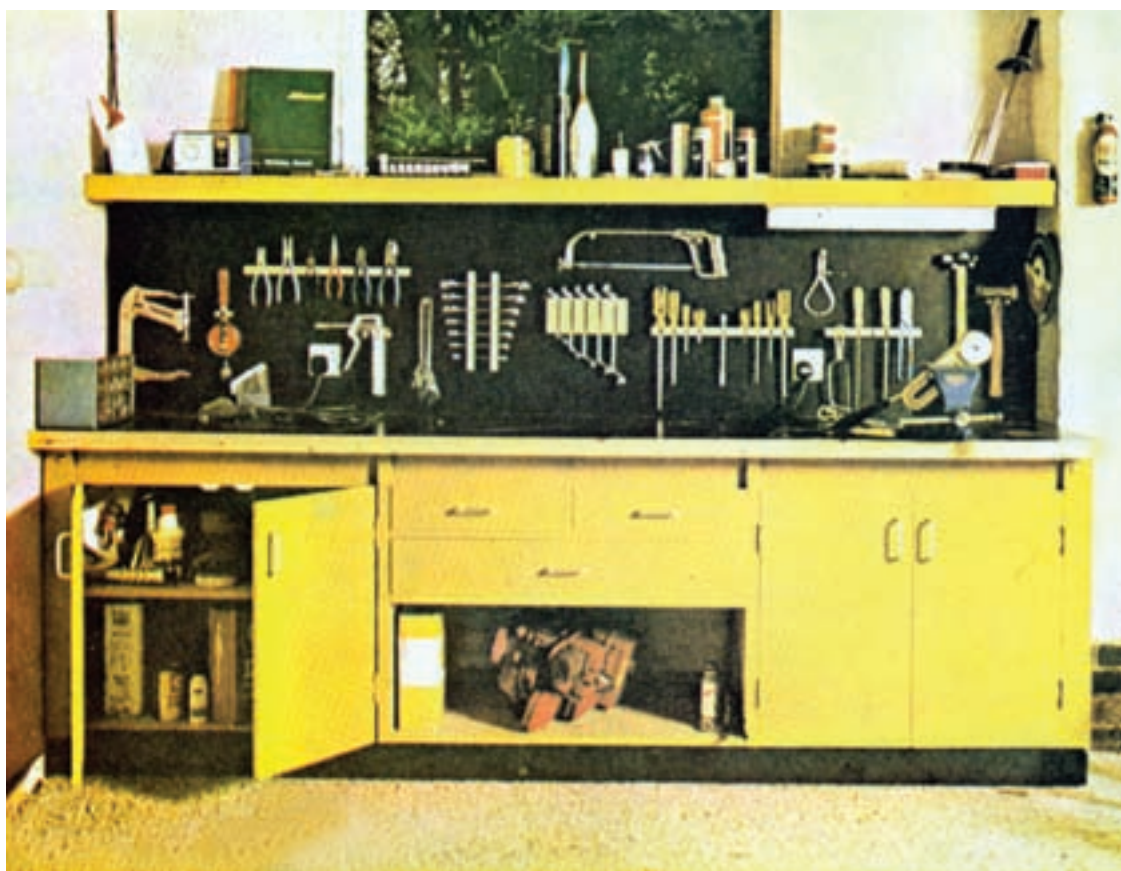
شکل ۱-۱- میز کار فلزی با تابلوی ابزار
