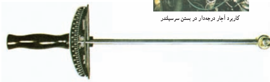
شکل ۸-۱ آچار درجه‌دار و کاربرد آن
