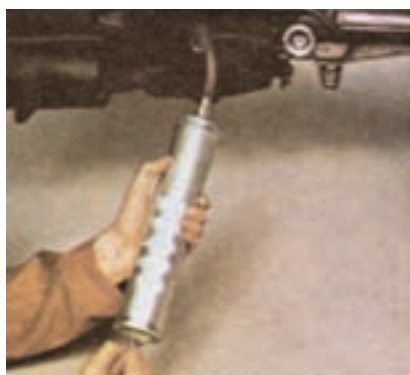
شکل ۳۹-۱- روش پر کردن گیربکس
