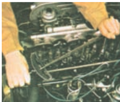
کاربرد آچار درجه‌دار در بستن سرسیلندر
