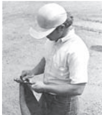
شکل ۱۳ - ۶ سرشیلنگی و مادگی را با پارچه تمیز کنید.
